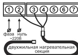
**Двухжильные нагревательные секции.** Выводы нагревательных секций (синий и коричневый провода) подключаются к клеммам 3 и 4, вывод экрана (желто-зеленый провод) – к клемме 2.
